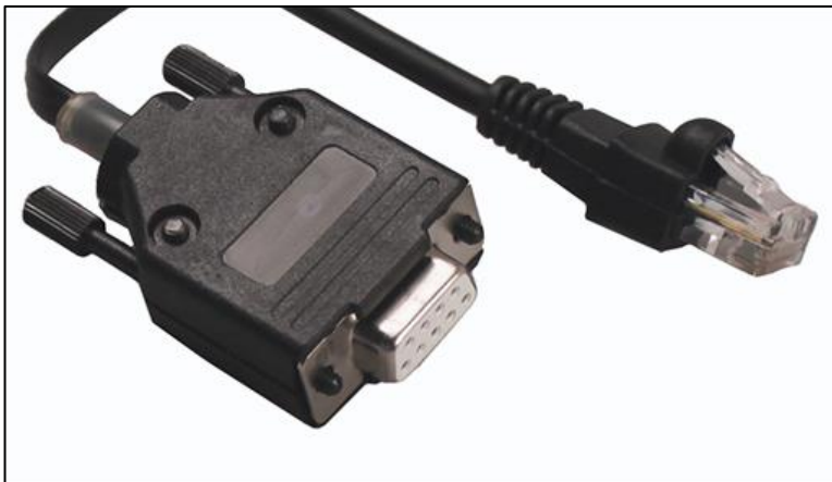
Abbildung 1: Links RS232-Stecker (D-Sub), rechts Westernstecker
