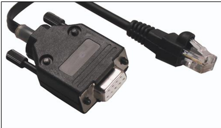
Abbildung 1: Links RS232-Stecker (D-Sub), Rechts Westernstecker
