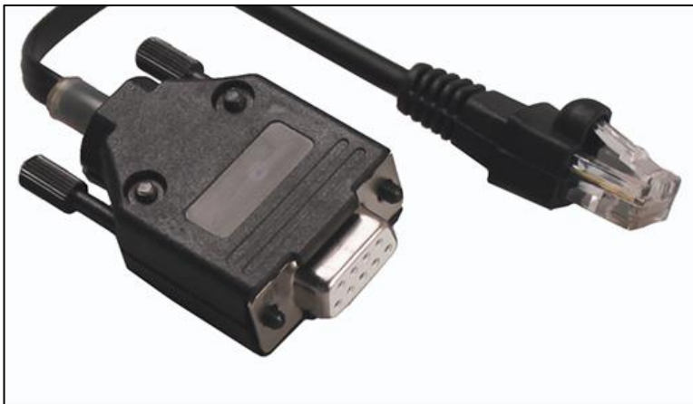
Abbildung 1: Links RS232-Stecker (D-Sub), Rechts Westernstecker
